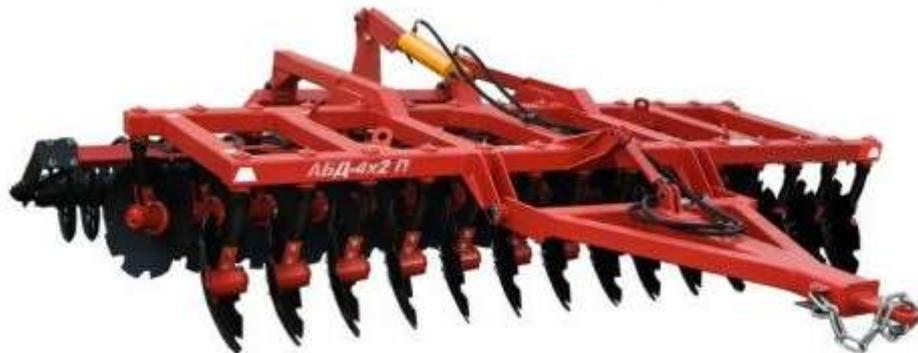
предназначен для ресурсосберегающей предпосевной и основной обработки почвы под зерновые, технические и кормовые культуры; для уничтожения сорняков и измельчения пожнивных остатков; для обработки почвы после уборки толстостебельных пропашных культур; для измельчения, выравнивания и уплотнения почвы после дискования.
